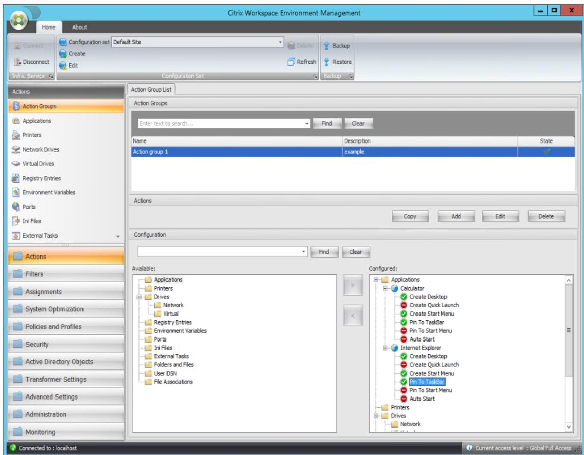
6. 转到 管理控制台 > 分配 > 操作分配 选项卡，然后双击适用的用户以在“可用”和“已分配”窗格中显示操作组。
