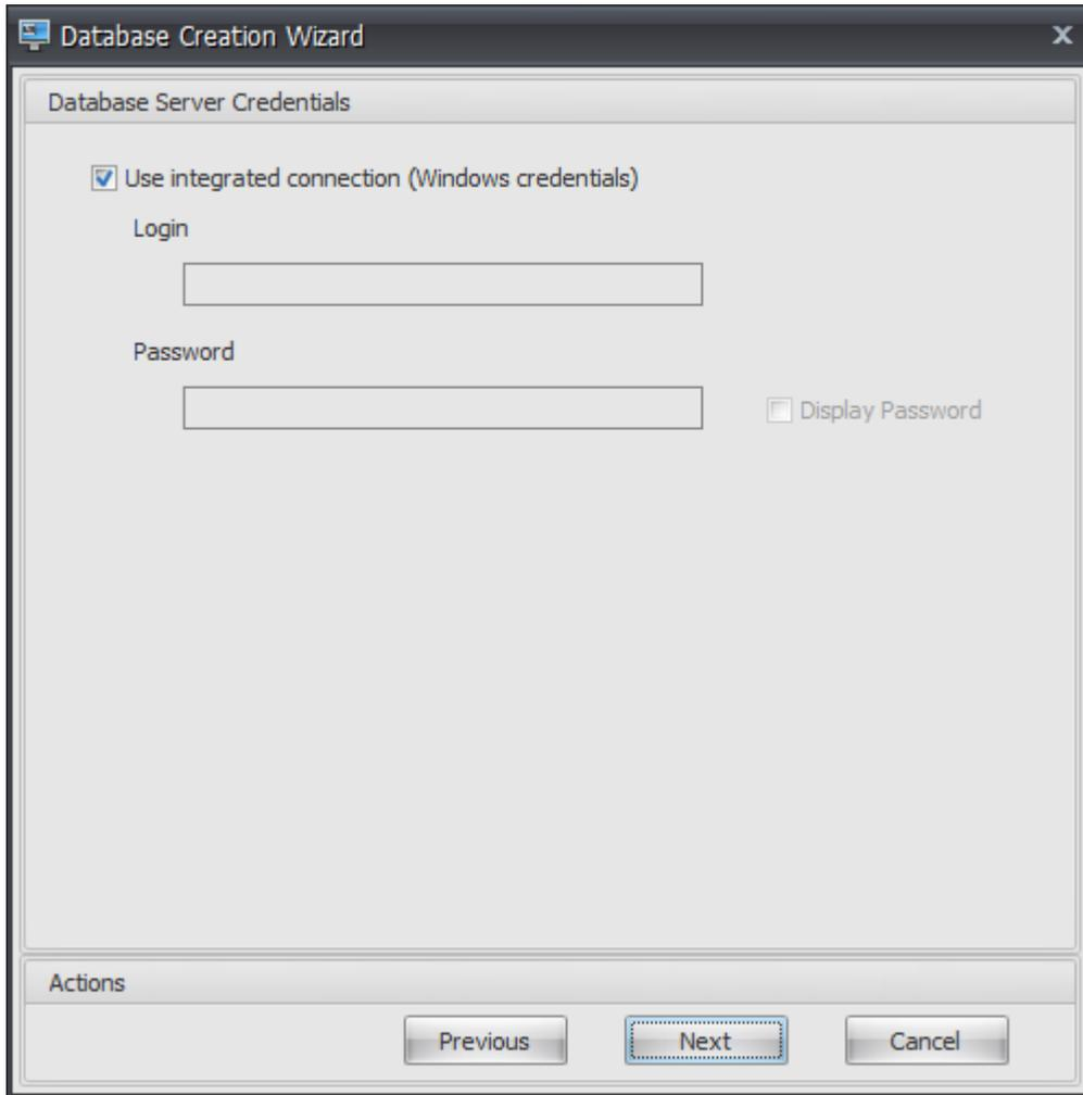
4. 提供向导可用于创建数据库的数据库服务器凭据，然后单击 下一步。这些凭据独立于基础结构服务在创建数据库后连接到数据库时使用的凭据。它们不会被存储。
