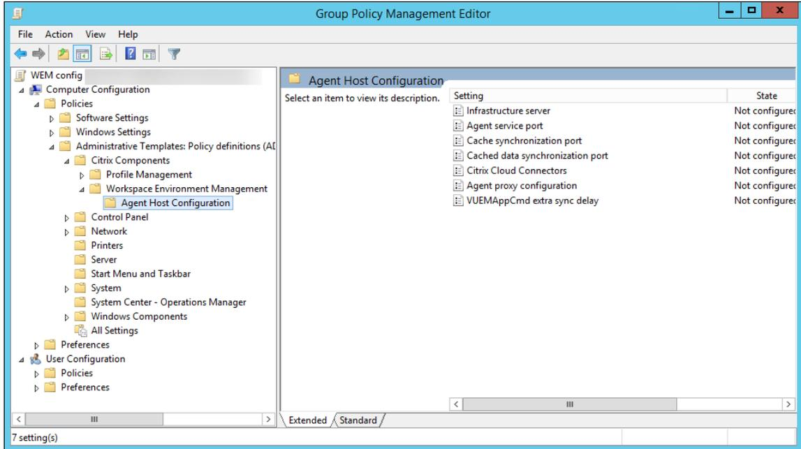
5. 在基础架构服务器窗口中，选择 已启用，然后在选项下键入安装基础架构服务的计算机的 IP 地址，然后单击 应用 和 确定。
