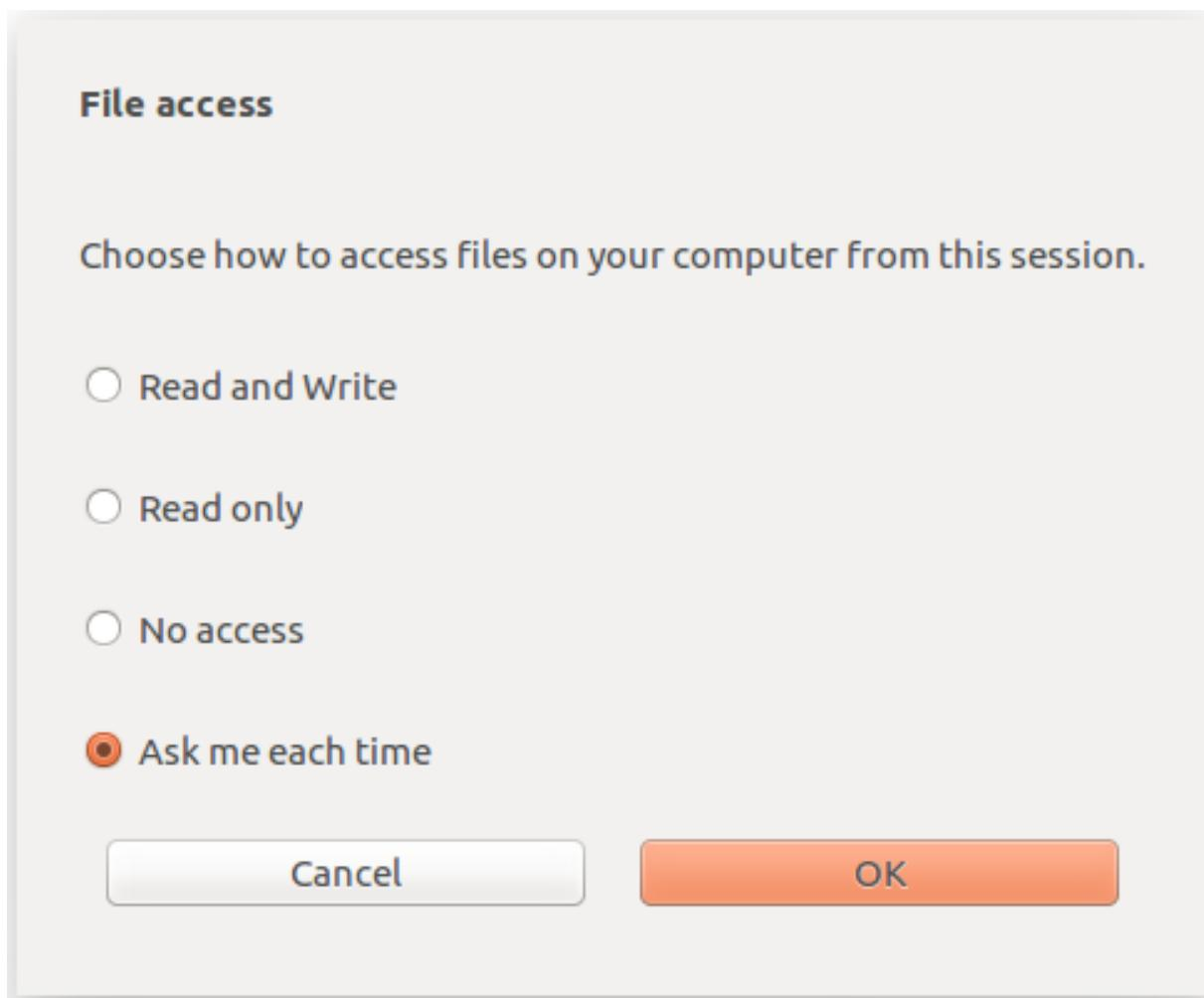
可以使用 `wfclient.ini` 文件配置映射的路径和文件名属性。使用 GUI 设置文件访问权限级别，如前面的屏幕截图所示。
