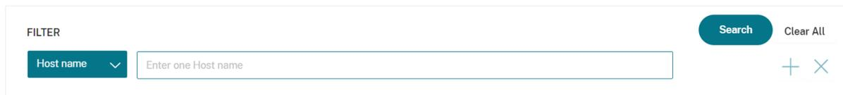
以下のスクリーンショットのように、現在選択されている [ホスト名] をクリックすると、別のフィルターに変更できます。[ホスト名] のクリック後、すべてのフィルターが一覧表示されます。必要に応じてフィルターを選択します。
